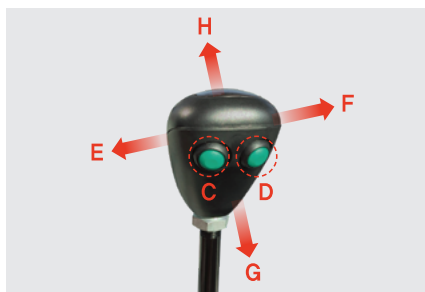
09_3rd Function 기본 적용 (RX730PSC5) 전/후방 6포트와 3rd Function 기본 적용으로 집게 작업 등 전방 작업기 효율 향상
