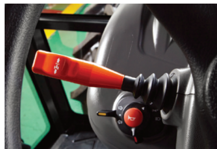
07_전·후진 파워셔틀 (PSC5 기종) 클러치를 밟지 않고도 손조작 하나만으로 전·후진 전환이 가능한 파워셔틀레버 장착 (작업 환경, 고객 선호에 따라 파워셔틀 및 기계식 셔틀 선택 가능)
