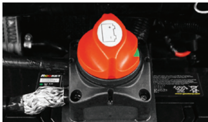
01_보관 시 방전을 방지하는 배터리 차단 스위치
