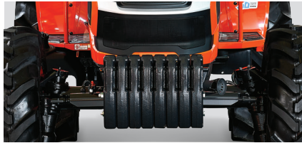
01 본넷 하단 및 전방에 설치된 250kg 은닉형 웨이트로 기체크기 최소화
