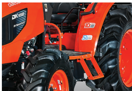
07_작업 효율성 증대 및 승하강성 증대 국내 트랙터 중 최저 의자높이 1,040mm
