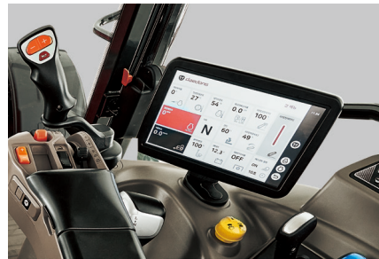
05_ 다기능 조작 모듈 (P 기종 적용) 전자식 암레스트 및 멀티 펀션 기능을 추가하고, 조작 스위치에 한글을 표기하여 편의 극대화
