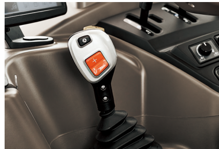
01_ 파워시프트 채택 (P 기종 적용) 부변속 레버와 암레스트의 간단한 버튼 조작으로 주변속 8단 변속이 가능하여 작업 편의성 대폭 증대
