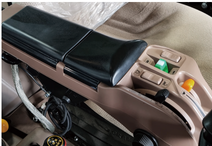
07_ 전/후방 조정 가능 전자식 암레스트 (P 기종 적용) 암레스트 전후방 이동으로 작동 레바 & 스위치 작동 편의성 개선
