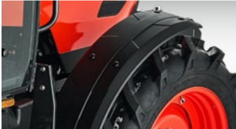
전륜 펜더 옵션 키트 운행 편의성을 증대하는 전륜 펜더 옵션 적용. 주행 작업 중 돌·흙 튼을 방지해 전면 유리 파손 방지. 핸들 조향에 따라 타이어-펜더가 함께 움직여 이물질 오염 방지. 타이어 사양에 따라 높이·폭 조절 가능
