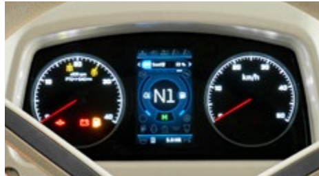
신규 디자인 클러스터 신규 GUI 디자인을 적용한 클러스터로 하이테크하고 세련된 이미지 강조. 4.3인치 컬러 LCD 디스플레이에 연비와 차속 등 다양한 정보 표시
