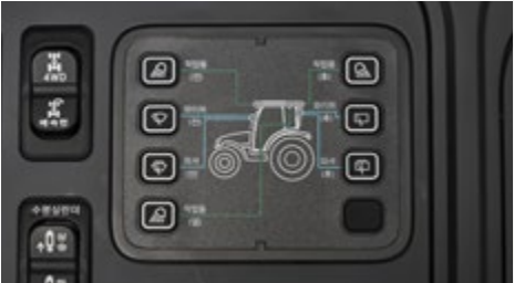
시인성을 높인 전장류 스위치 작업등과 와이퍼에 트랙터 이미지와 화살표를 추가해 시인성 증대
