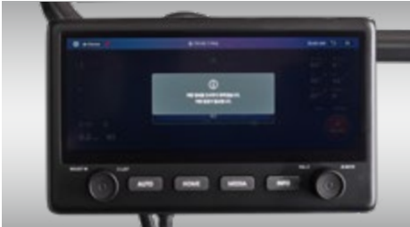
12.3인치 모니터(자율주행 Only) 주행속도, 엔진RPM 등 트랙터 상태를 확인하나 공조제어 가능.(A-MOTION 기종한정)
