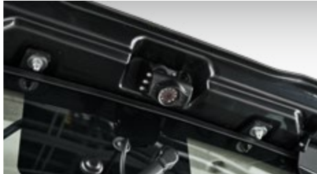
후방 카메라 & 모니터 키트 작업 모니터링이 가능한 룸미러형 후방카메라 옵션 키트 장착
