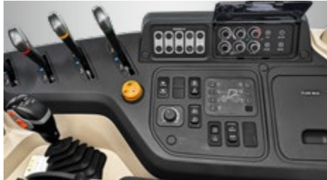
레버와 스위치 그룹화 및 고급화 레버와 스위치를 작업 용도 유사성으로 그룹화해 조작 편의성 향상. 스위치 박스 디자인 고급화 및 마감 품질 개선
