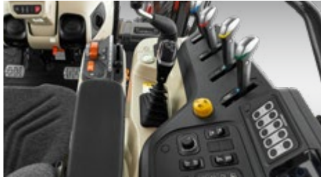
경사면으로 디자인한 스위치 박스 가장 편안한 자세로 기능을 조작할 수 있도록 스위치 박스를 경사면으로 디자인해 조작 편의성 향상
