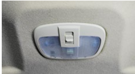
실용적인 실내등 천장 중앙부와 우측 후방에 각각 1개씩 실내등 설치. 야간작업 시 실내 장치를 잘 볼 수 있어서 안전하고 능률적인 작업 도모
