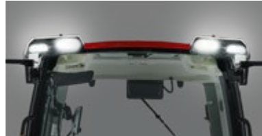
LED 전후방 작업등 LED 작업등을 전방 4개, 후방 2개 설치. 업계 최초 후방 40W 작업등 적용. 기존 대비 밝기 2배 증가. 측면 사이드 작업등 옵션 추가
