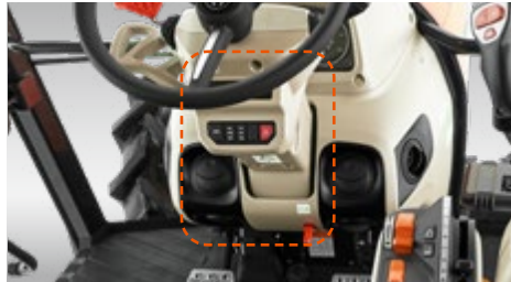
사용성을 개선한 칼럼 칼럼 커버 위치를 높여서 스티어링 휠 사용성을 개선하고 서틀 레버와 콤비 스위치 조작 편의성 개선
